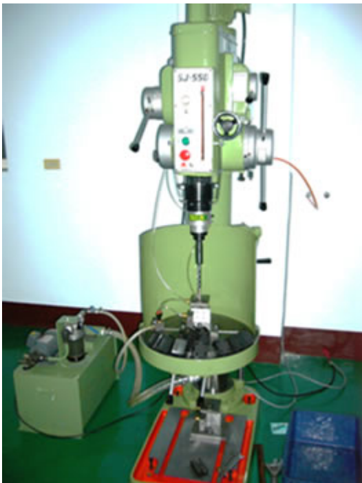
直立ボール盤に Oscillation 装置の取付け写真
